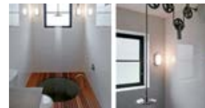
Fig.14-Cameră de baie, arhitecți Lance Workshop – instalație nonconvențională). http://www.contemporist.com/2015/08/19/a-pulley-system-adjusts-the-shower-height-above-a-sunken-concrete-bath-
